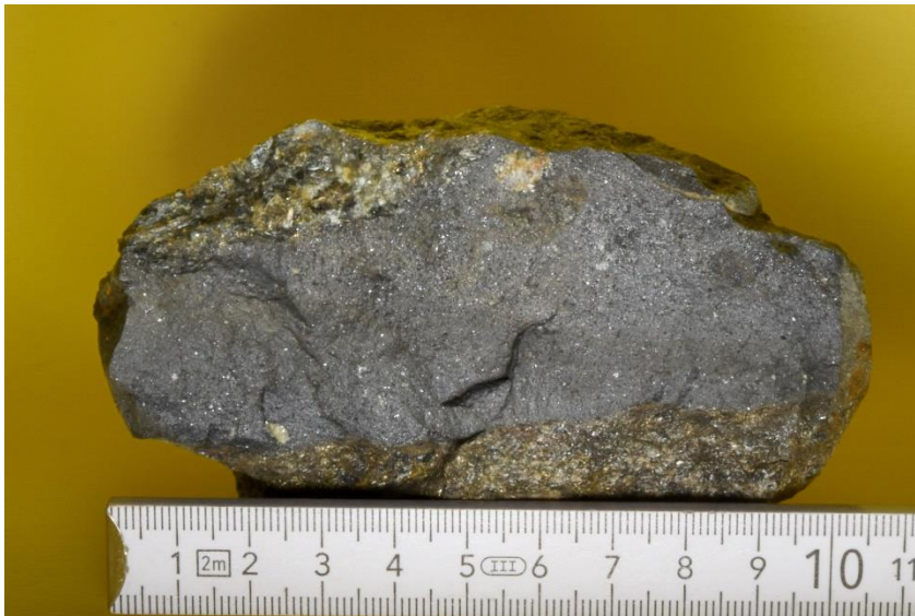
Abbildung 4.4: Erscheinungsbild des feinkörnigen Sphalerites, eingelagert in Biotitreichem Nebengestein. Bei den Porzellanweißen Einsprenglingen handelt es sich um Karbonate (Foto: Volkmar Mair)
