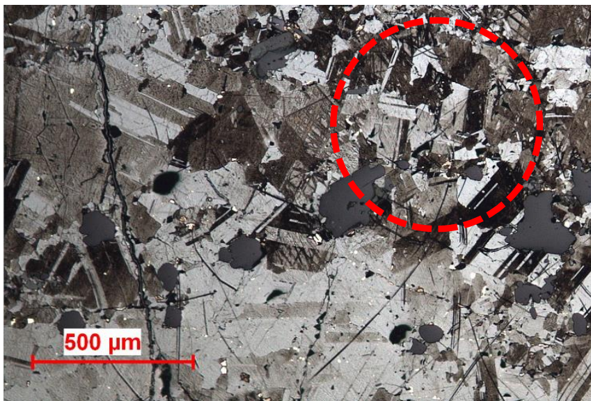
Abbildung 5.6: ZnS-Typ 2: Die Körner haben eine Größe von min. 50 µm (siehe rot eingerahmter Bereich)
