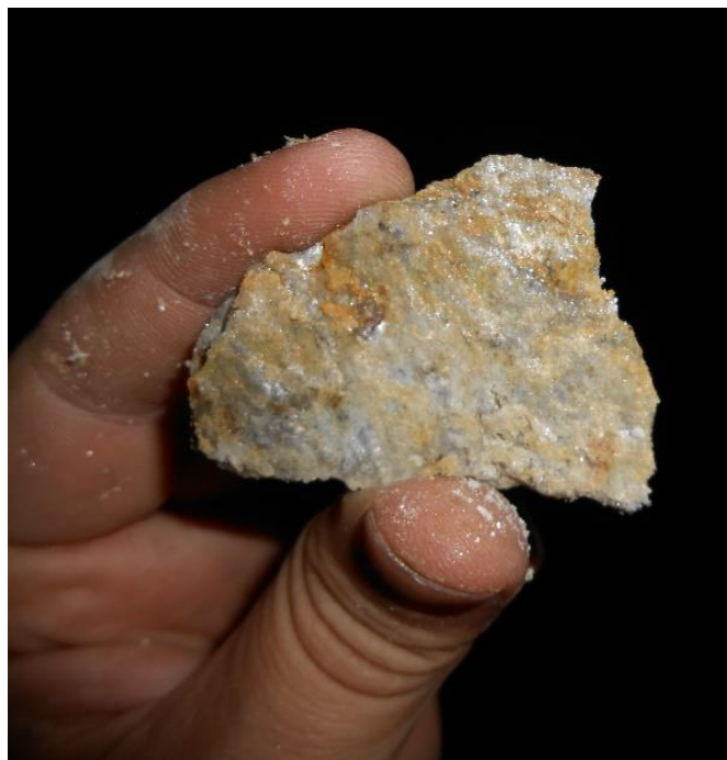
Abbildung 3.6: Typischer Muskovit-Quarz-Schiefer. Makroskopisch war bereits der hohe Anteil an Hellglimmer zu erkennen.
