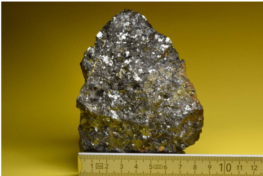
Abbildung 4.5: Erscheinungsbild des grobkörnigen Sphalerites. Die Kristalle erreichen eine Größe von bis zu 1 cm. Bei den gelblichen Einsprenglingen handelt es sich um Karbonate und Anthophyllit (Foto: Volkmar Mair)
