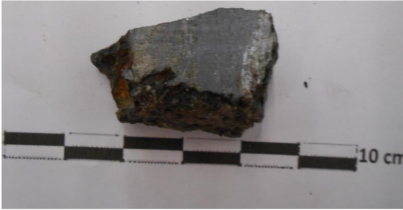
Abb. 4.3: Massiger Sphalerit – Galenitanschliff (Probe 133-VP54)
